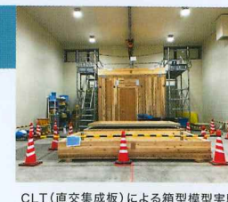
CLT(直交集成板)による箱型模型実験
