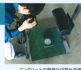
コンクリートの微細ひび割れ評価
