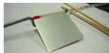
陽極酸化処理したテストピース。
