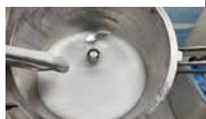
直径約500mmの鋭い刃がある カッターミキサー。
