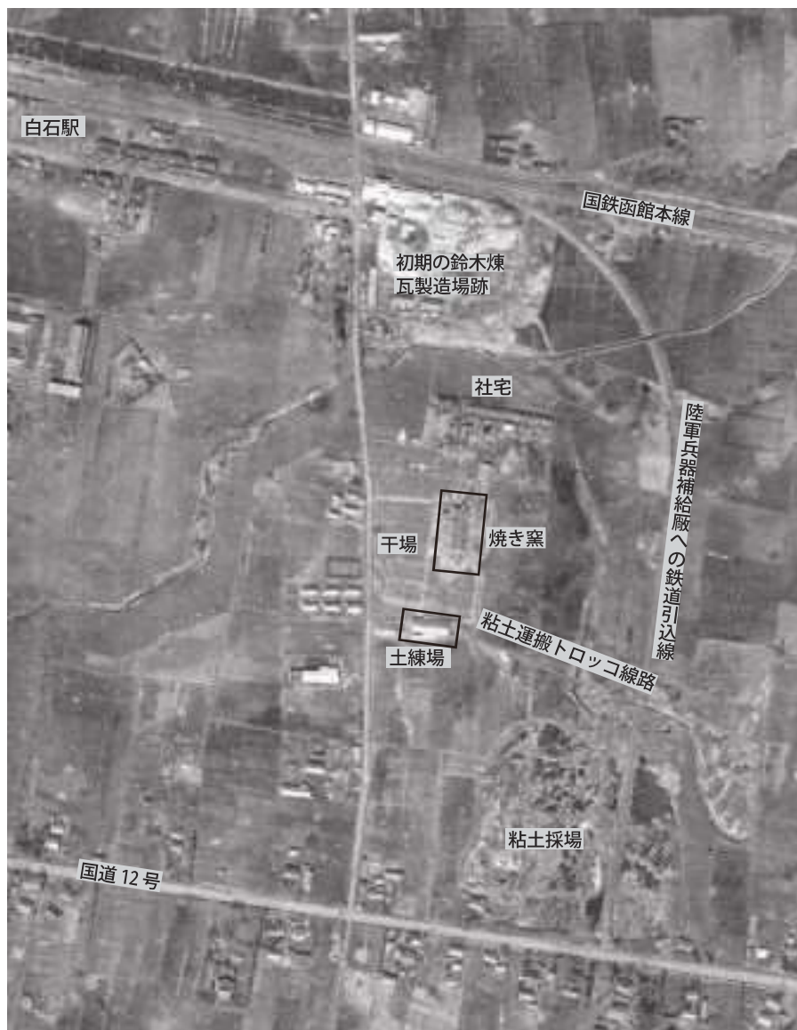
昭和23年頃米軍撮影の航空写真に見る鈴木煉瓦製造場跡。粘土は採取場から馬でトロッコ2、3台を引き、土練場まで運んだ。閉鎖後経営者が替わり、昭和26年頃までレンガの製造が行われていた。
