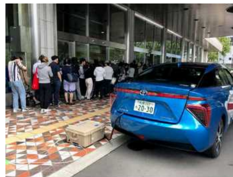
災害時の燃料電池による電力供給（出典：札幌市）
