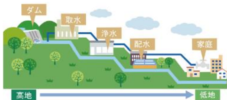
【図表18】自然流下方式の概念図
