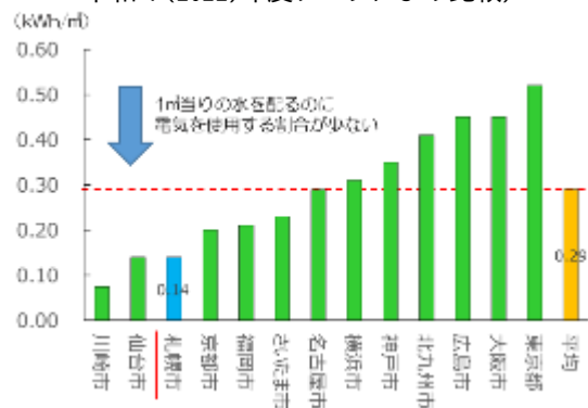
【図表19】配水量1m 3 当たりの電力消費量 (計画給水人口が100万人以上の13都市の 令和4(2022)年度データにより比較)
