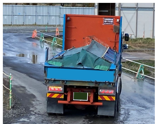
荷台のシート状況
