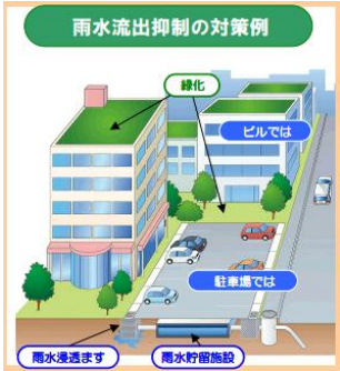
雨水流出抑制対策のイメージ
